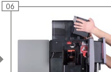
06 Pulverbehälter nach oben abheben. Pulverbehälter leeren.
