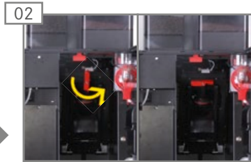
02 Brühmodulverriegelung im Gegenuhrzeigersinn lösen.
