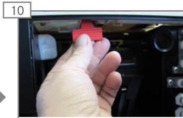
10 Verriegelungsschieber ganz hineinschieben.
