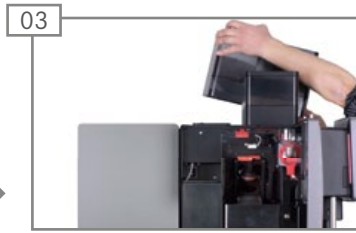
03 Bohnenbehälter nach oben abheben. Bohnenbehälter leeren.
