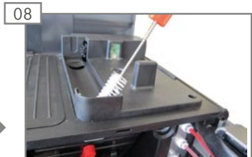
08 Pulverrutsche mit Bürste reinigen.
